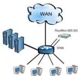
FlowMon Probe 2000 の監視ポートはコアスイッチの SPAN ポートと DMZ スwitch の SPAN ポートに接続されます。これらのスイッチはこれらの監視ポートを通してすべてのネットワーク通信をミラーリングします。
